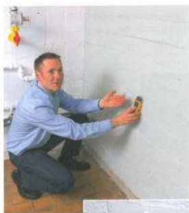
Dipl.-Bauingenieur Karsten Samland hat eine eingehende Schadensanalyse und Feuchtigkeitsmessungen in allen betroffenen Kellerräumen vorgenommen.
