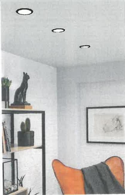
Die dreistufig dimmbaren Einbauspots der Produktlinie „Cole“ eignen sich zum Nachrüsten für abgehängte Decken mit einem Hohlraum von mindestens 55 mm. Paulmann Licht
